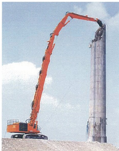
使用予定解体重機
